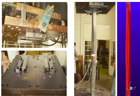
شکل ۲- طرز قرار گیری نمونه در تکیه‌گاه مفصلی [۷]
