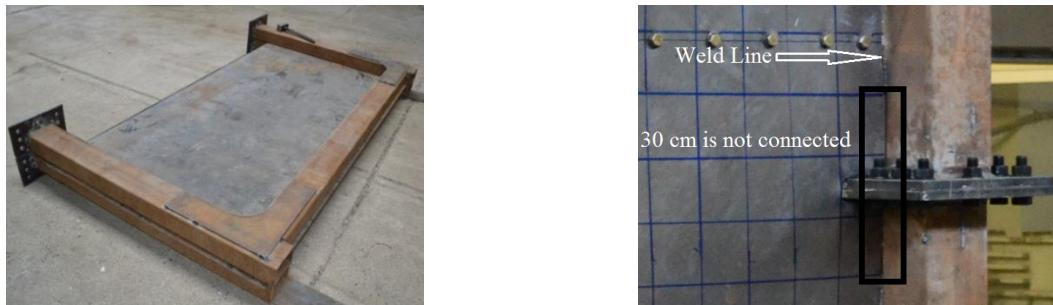
ب) تصویر ناجیه عدم اتصال ورق جان به المان مرزی قائم در نمونه ساخته
