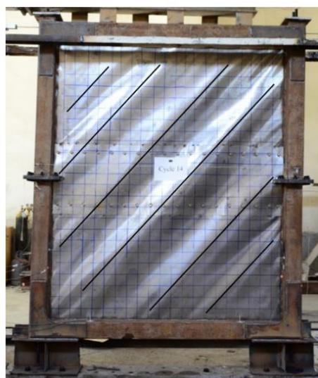
شکل ۹- شکل گیری تقریباً موازی نوارهای کششی در نمونه مورد آزمایش با نسبت عدم اتصال ۱۲
