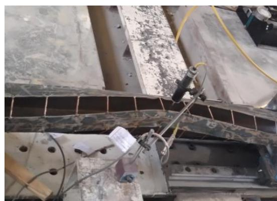
شکل ۱۷- تسلیم و کمانش کلی نمونه
