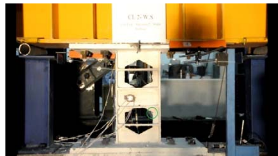
شکل (۱۵): نمایش اولین گسیختگی جان نمونه شماره دو (CL2-W.S)
