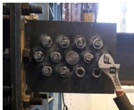
شکل ۲۲- بستن میراگر در گره اتصال نمونه آزمایشگاهی (CPYD1)
