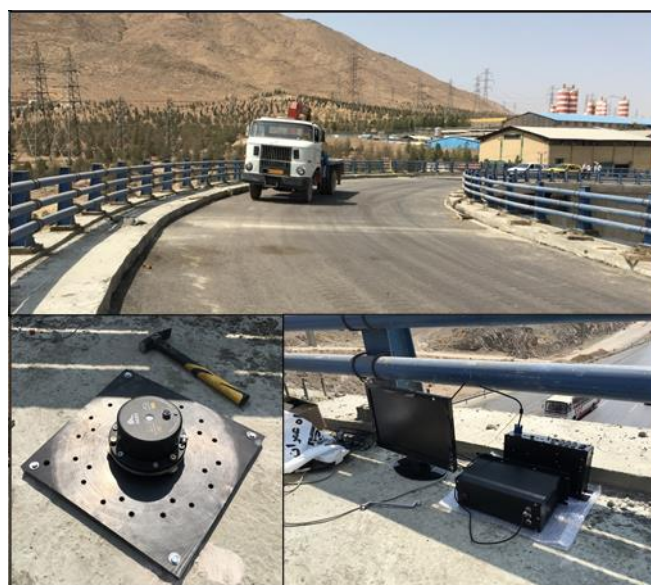
شکل ۶- آزمون میدانی پل با استفاده از شتاب سنج
