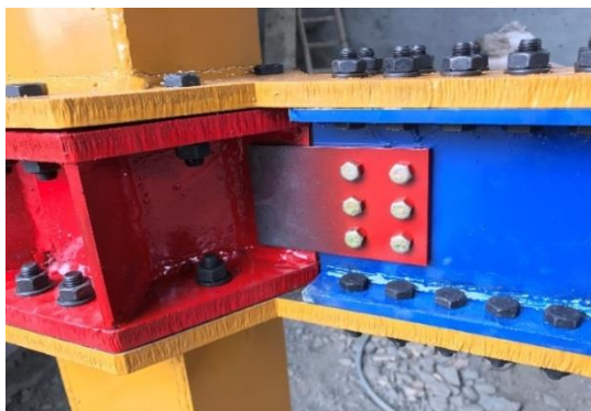
شکل ۳- ماکت اجزا اتصال برای حالت اتصال شش تیر به ستون قوطی
