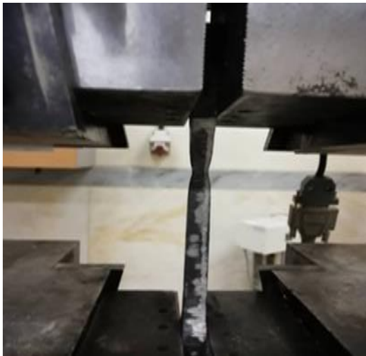
شکل ۶- تست کشش جهت تعیین مشخصات فولاد
