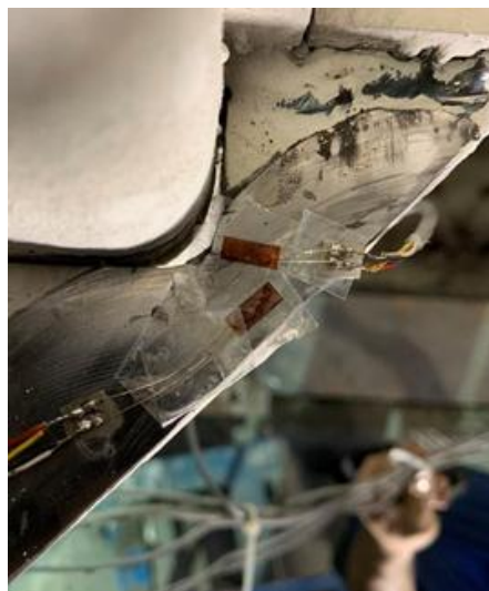
شکل ۹- کرنش سنج‌های چسب‌بند شده روی دیافراگم خارجی در نمونه TSTBOD
