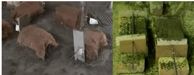
شکل ۱۰- نمونه‌ها در مراحل ساخت: (الف) نمونه‌ها در حال شات‌کریت شدن، (ب) نمونه‌ها در حال عمل‌آوری
