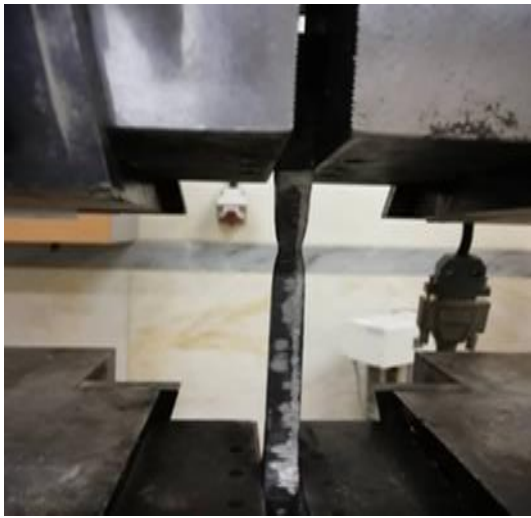
شکل ۶- تست کشش جهت تعیین مشخصات فولاد
