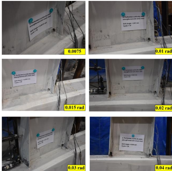
شکل ۱۵- وضعیت نمونه ۲ (PCPS) طی مراحل بارگذاری
